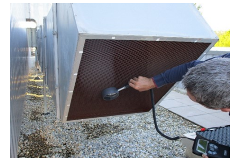
Mesure de vitesse au moulinet
